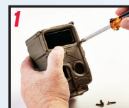
1. Remove the front bezel
